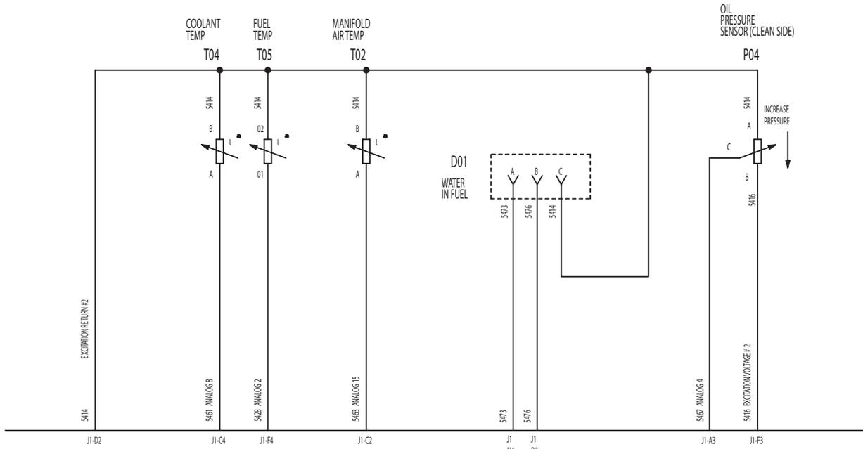
**(A)** FOCUS 16.4.5L 4 VALVE ENGINE CONTROL UNIT (ECU)      J1 32 POSITION - BLACK      J2 48 POSITION - BROWN      J3 32 POSITION - BLUE
