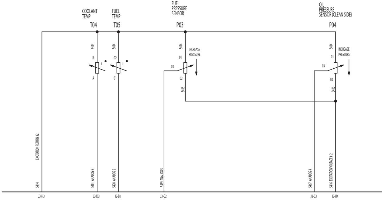
(A) FOCUS 14.5L 4 VALVE ENGINE CONTROL UNIT (ECU)      J1 32 POSITION - BLACK      J2 48 POSITION - BROWN      J3 32 POSITION - BLUE
