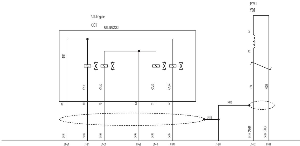
A FOCUS 14.4.5L 4 VALVE ENGINE CONTROL UNIT (ECU)    J1 32 POSITION - BLACK    J2 48 POSITION - BROWN    J3 32 POSITION - BLUE
