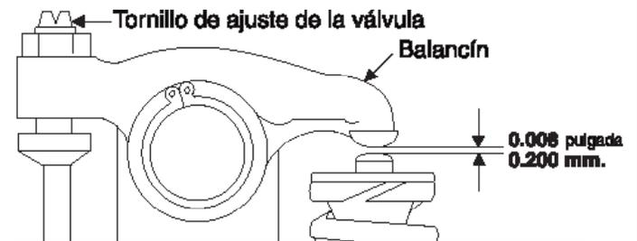
Figura 10: Ajuste de una válvula
