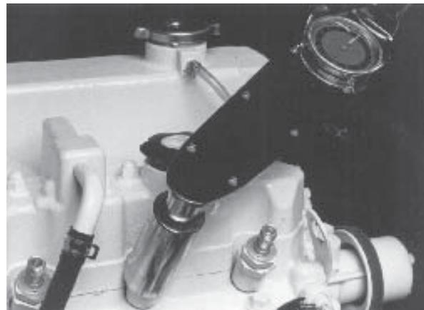
*Figura 18: Vuelvo a instalar el inyector. Apriételo a la tensión apropiada.*
