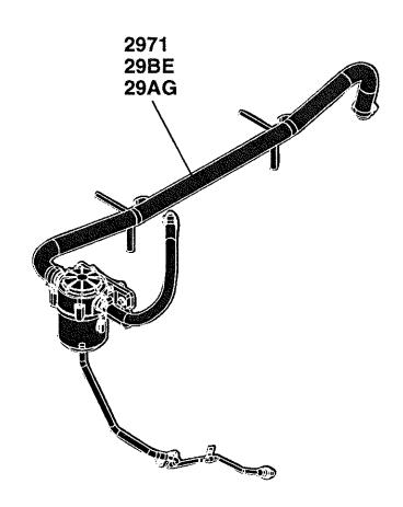
2971 Crankcase Vent Filter 2971 Filtre d'évent du carter-moteur 2971 Kurbelgehäuse-Entlüftungsfilter 2971 Filtro sfiato basamento 2971 Filtro de orificio de ventilación del cárter 2971 Vevhusets ventilationsfilter
