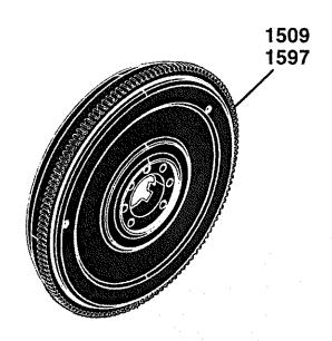
1509 Flywheel 1509 Volant-moteur 1509 Schwungrad 1509 Volano 1509 Volante de motor 1509 Svänghjul 1509\_RE59289\_PCD A.3
