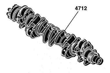
4712 Crankshaft and Bearings 4712 Vilebrequin et paliers 4712 Kurbelwelle und Lager 4712 Albero a gomiti e cuscinetti 4712 Cigüeñal y cojinetes 4712 Vevaxel och lager
