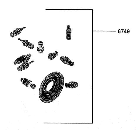
6749 Engine Sensors 6749 Capteurs du moteur 6749 Motorsensoren 6749 Sensori motore 6749 Sensores de motor 6749 Motorsensorer 6749\_RE538501\_PCD C.1
