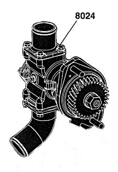
8024 Sea Water Pump 8024 Pompe à eau de mer 8024 Seewasserpumpe 8024 Pompa dell'acqua di mare 8024 Bomba de agua de mar 8024 Havsvattenpump
