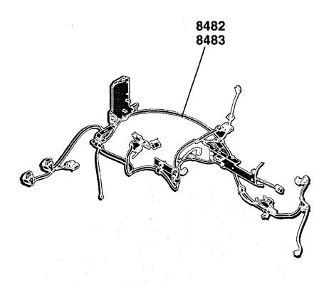
8482 Engine Wiring Harness 8482 Faisceau de fils de moteur 8482 Motorkabelbaum 8482 Cavo elettrico motore 8482 Grupo de cables de motor 8482 Motorns kabelhärva
