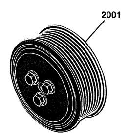
2001 Water Pump Pulley 2001 Poulie de pompe à eau 2001 Wasserpumpenriemenscheibe 2001 Puleggia pompa acqua 2001 Polea de la bomba de agua 2001 Vattenpumpens remskiva
