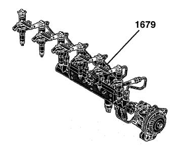
1679 Fuel Injection Pump 1679 Pompe d'injection 1679 Kraftstoffeinspritzpumpe 1679 Pompa di iniezione 1679 Bomba de inyección de combustible 1679 Bränsleinsprutningspump
