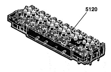
5120 Cylinder Head 5120 Culasse 5120 Zylinderkopf 5120 Testata cilindri 5120 Culata 5120 Topplock
