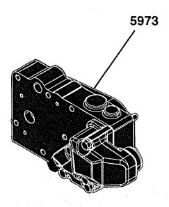
5973 Oil Cooler 5973 Refroidisseur d'huile 5973 Ölkühler 5973 Scambiatore di calore olio 5973 Refrigerador de aceite 5973 Oljekylare
