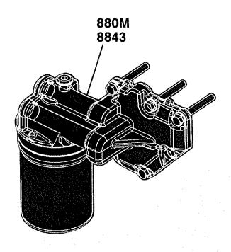
880M Engine Oil Filter 880M Filtre à huile moteur 880M Motorölfilter 880M Filtro olio motore 880M Filtro de aceite de motor 880M Motoroljefilter
