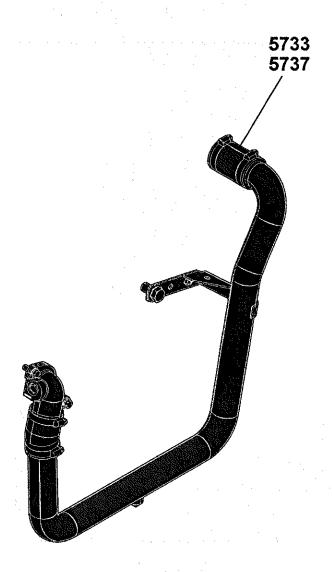
5733 Water Pump Inlet 5733 Entrée de pompe à eau 5733 Wasserpumpeneinlass 5733 Ingresso pompa acqua 5733 Entrada de bomba de agua 5733 Vattenpumpinlopp
