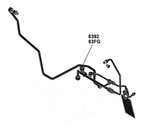
6392 Fuel Lines 6392 Conduites de carburant 6392 Kraftstoffleitungen 6392 Tubi alimentazione combustibile 6392 Lineas de combustible 6392 Bränsleledningar
